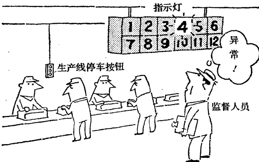
例如，有一条生产线是由1—12道工序组成的。现在，第4道工序因某种原因生产线停车，第4道工序的指示灯立刻就亮了。附近的监督人员马上赶到现场，查找原因，进行技术处理。
